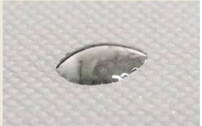
Gut benetzbarer Untergrund. Die Oberflächenenergie ist hier hoch genug, um das Wasser zu spreiten (auszubreiten).
