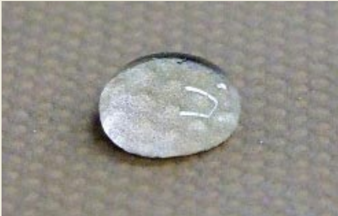
Schlecht benetzbarer Untergrund. Das Wasser bildet hier aufgrund seiner Oberflächenspannung eine Kugel.
