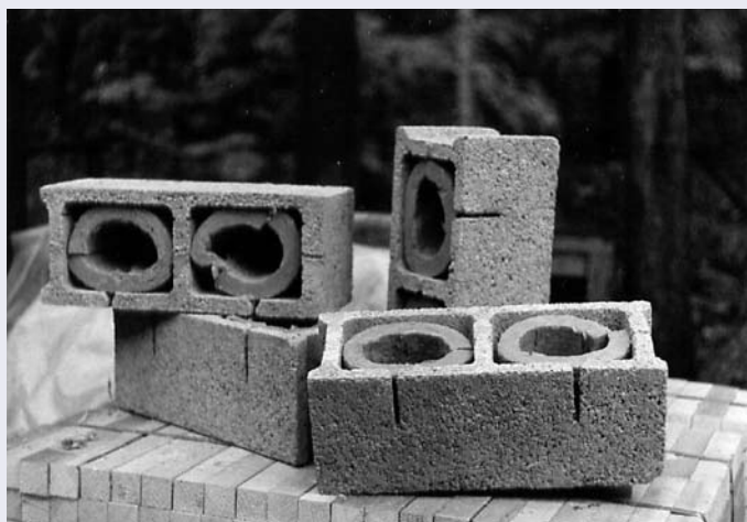
Abbildung 3: Absorbersteine mit eingelegtem Dämpfungsmaterial (z. B. Mineralwolle), um auf diese Weise einen etwas breiteren Absorptions-Frequenzbereich zu erzielen. Der Absorptionsgrad \alpha bei f_{res} wird dadurch allerdings etwas geringer. Die Mittenfrequenz solcher Absorbersteine liegt zwischen etwa 160 und 250 Hz. Die Steine werden so übereinander gestapelt, dass der aufgelegte Stein den darunter liegenden zu einem abgeschlossenen Resonator verschließt. Die Resonatoröffnung (siehe Resonatorhals in Abbildung 1) bilden hier schmale Schlitzte. Mit derartigen Steinen lassen sich ganze „Absorber-Wände“ zum Einsatz an geräuschintensiven Verkehrswegen aufbauen.
