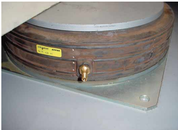
Abbildung 3: Elastische Lagerung mit Hilfe von Luftfedern, die eine besonders gute Absenkung der Körperschallübertragung bei tiefen Frequenzen ermöglichen. Damit sind Resonanzfrequenzen bis zu 2,5 Hz herab erreichbar.
