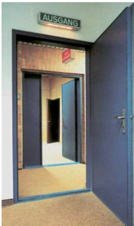
Abbildung 3: Hochschalldämmende Stahltür. Das Türblatt besteht aus einer stabilen, verwindungsfreien Stahlprofilkonstruktion mit zwei Deckplatten aus Stahlblech und einer Mineralwolleeinlage.
