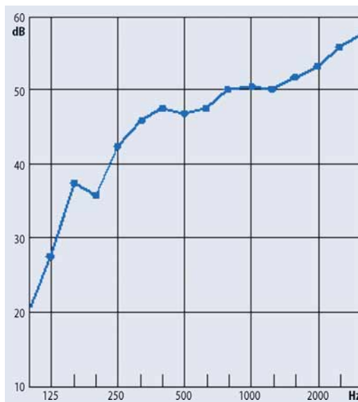
Abbildung 4: Schalldämmmaß R in Abhängigkeit von der Frequenz und bewertetetes Schalldämmmaß R'_w einer 56 mm dicken TSS-6 Tür, Abmessungen 825 x 1845 mm.
